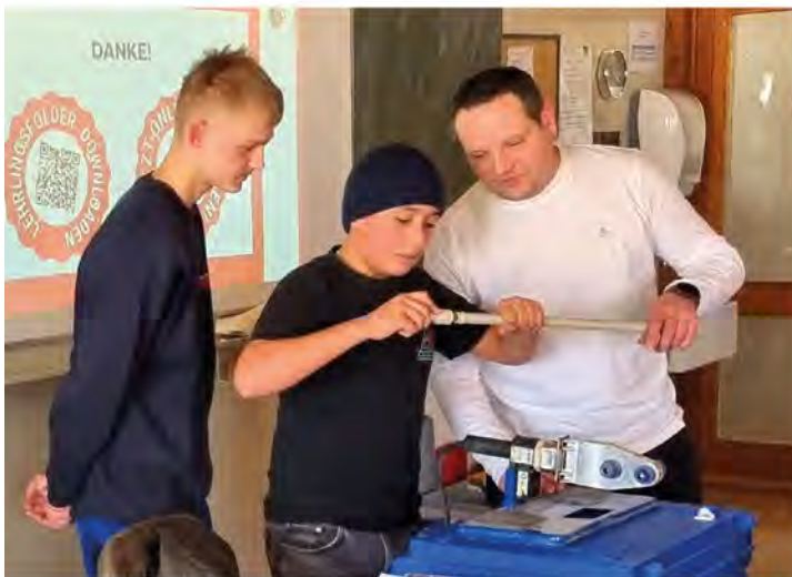
Unser Lehrling Marcel (l.) und GF Christian Voit beim Schweißen von Kunststoffdruckleitungen mit einem Schüler.
